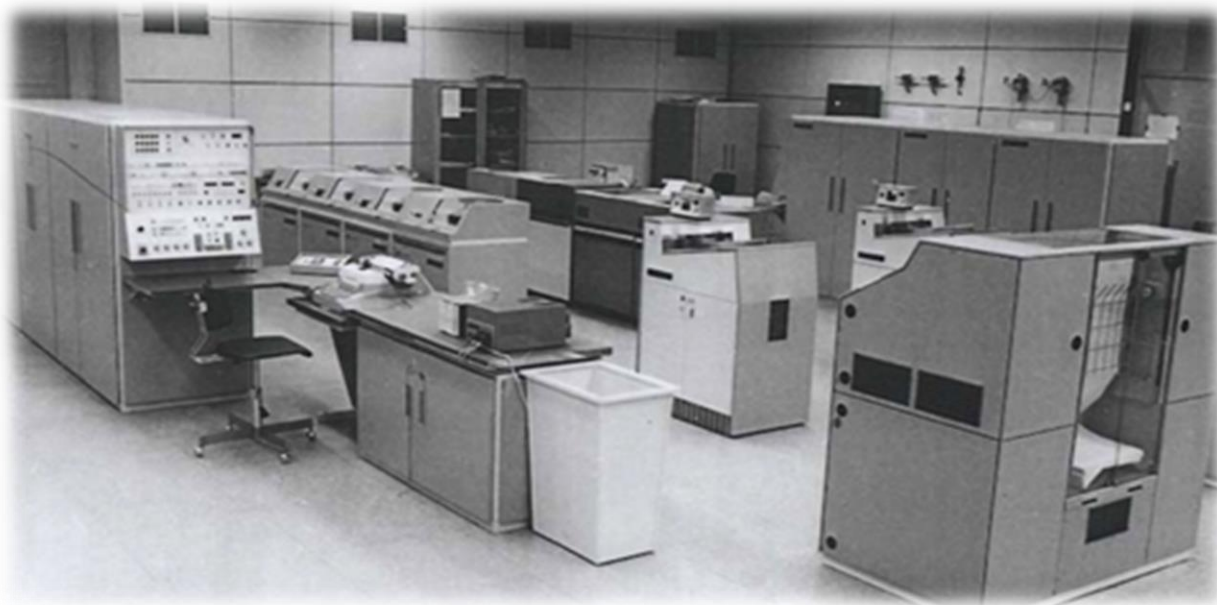
1.9-rasm. A.I.Kitov boshchiligida dunyodagi eng tez chiroqqa asoslangan M-100 kompyuteri
